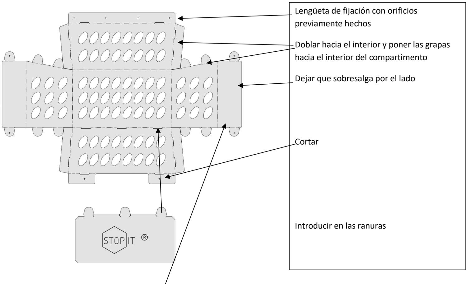
Medir la piqueta y cortar según las dimensiones de forma que la placa del compartimento repose sobre la piqueta
