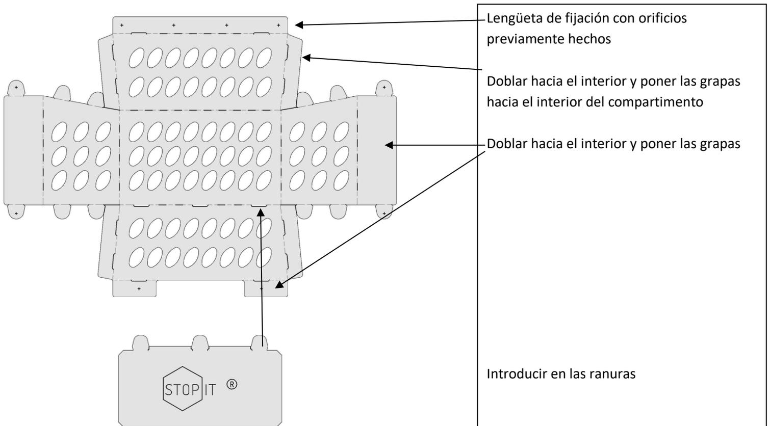
Fijar la colmena pequeña con grapas o tornillo utilizando los orificios ya hechos
